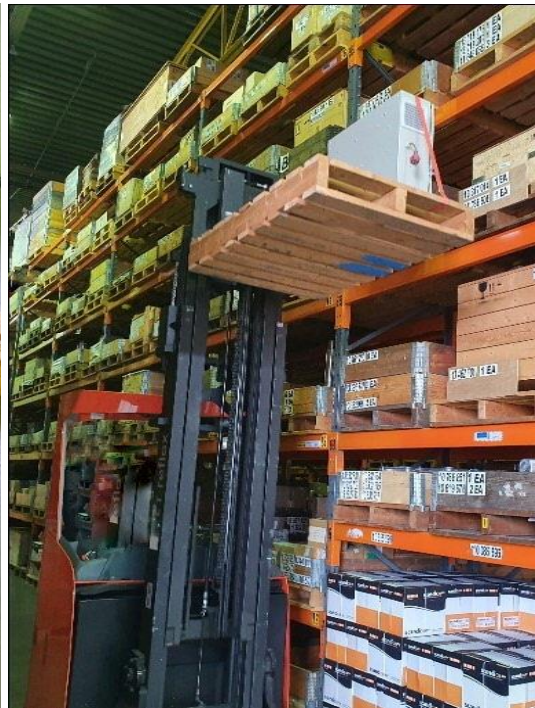
Figur 7: RFID leser montert på stockpalle Figur 8: RFID leser skanner etter tags
