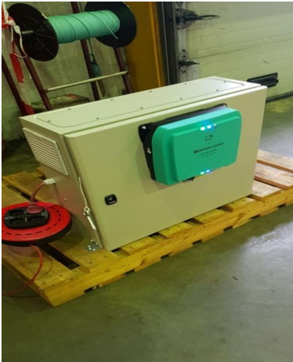
Figur 7: RFID leser montert på stockpalle Figur 8: RFID leser skanner etter tags
